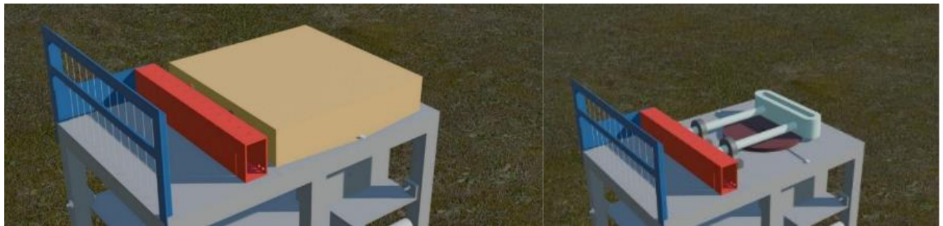
Figuras 6 y 7. Sistema mecánico compuesto por motorreductor y mecanismo excéntrico.
