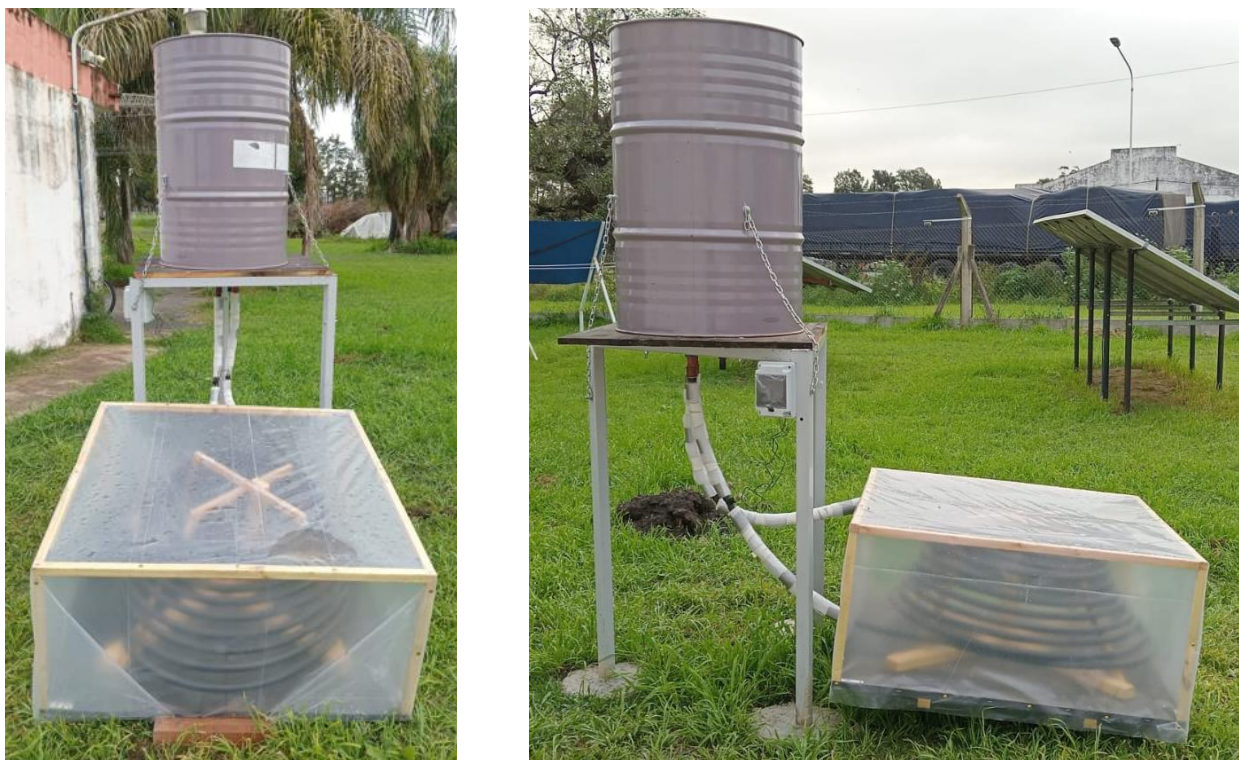
Figura 1, Sistema de almacenamiento de agua y sistema captador/calentador a energía solar.
